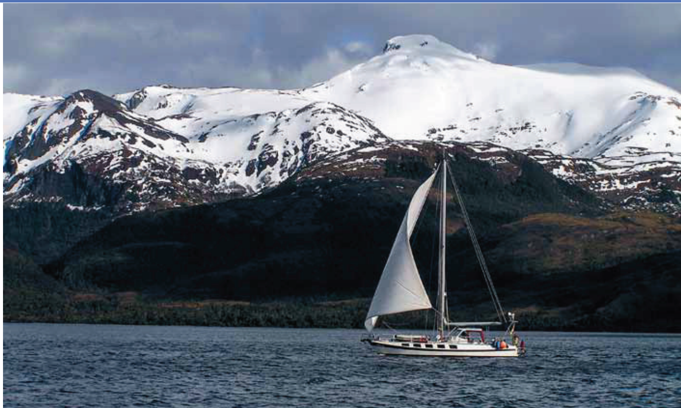
S/Y Orca är en 45 fot segelbåt i stål. Modell: Modifierad Super Secura. Konstruktör: Reinke. 17 ton, 1,20/2,80 djupgående, 14 m LÖA.
